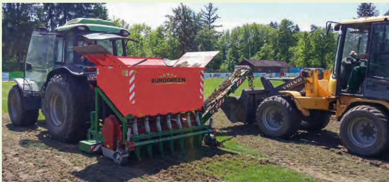
Die Eurodrain-Schlitzfräse bei der Arbeit
